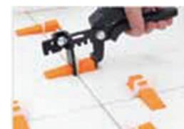
「調整機能付き専用ペンチ」は、「スペーサークリップ」に「くさび」の締めすぎを防止しながら素早く正確に必要な位置まで挿入することが出来ます。
